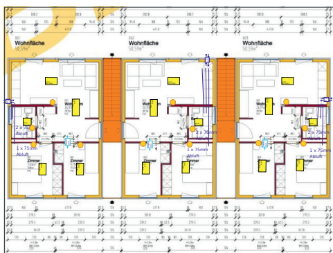
Planung des Lüftungssystems und der Infrarotheizung
