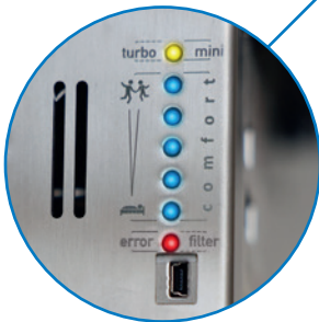
LED Anzeige links, USB Anschluss
